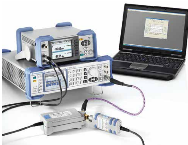
Измерительная установка для калибровки преобразователя мощности NRP-Z55
