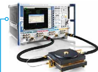
Измерение параметров пленок на основе резонатора
