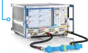
Измерение параметров материалов в волноводе
